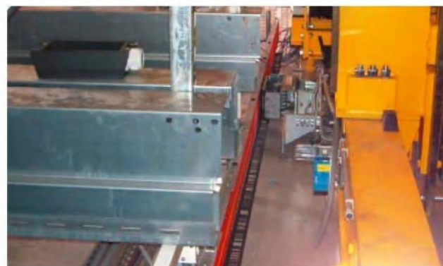
10 极 Pro-Ductor 配合编码条一起使用
