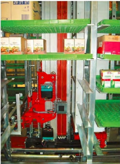
安装在低载荷的堆垛机升降杆上的滑线系统 7 极 Pro-Ductor 滑线系统
