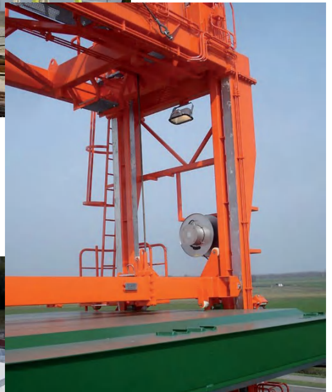
AV50电缆卷筒 (不锈钢) 给货运 船上的门座式起重 机供电
