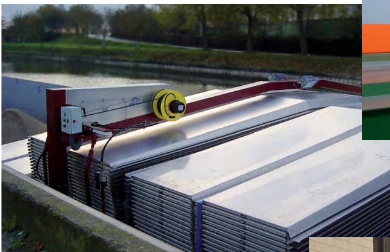
AV28电缆卷筒用于货运船舶舱口起重机供电和控制
